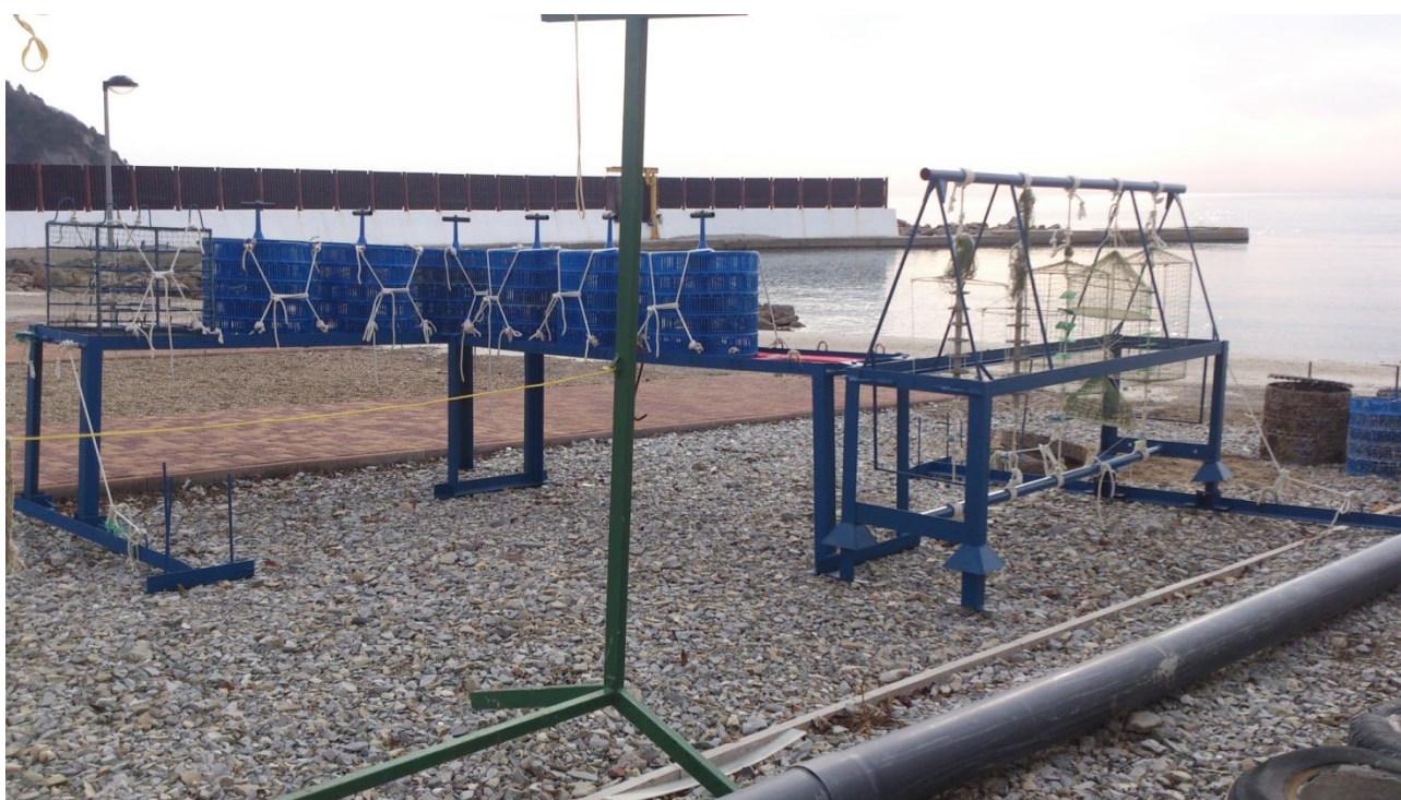
Рисунок 22 Связка донных столов, слева стол с прямоугольным садком, справа стол с вынимаемой кассетой
